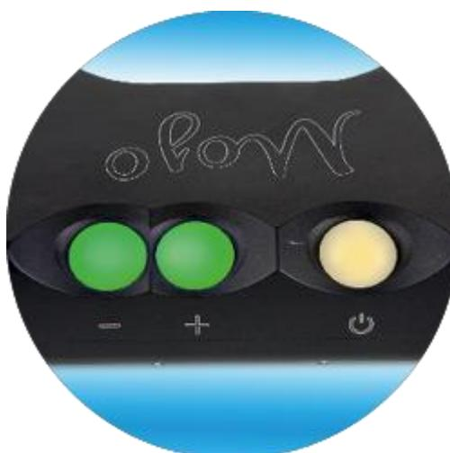
*Кнопки громкости меняют цвет в зависимости от уровня громкости, а выключатель показывает частоту дискретизации входного сигнала*
